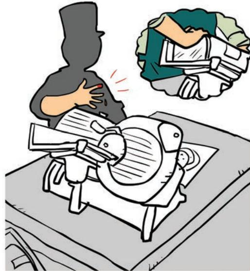
■ Comprueba siempre que las máquinas mantienen los medios de protección (guías, empujadores, resguardos...) y úsalos. ■
